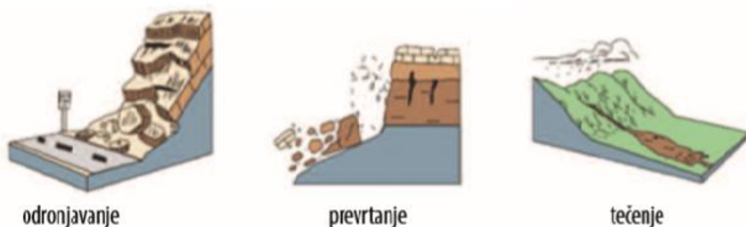
Slika 27.: Prikaz osnovnih tipova klizanja prema mehanizmu kretanja
