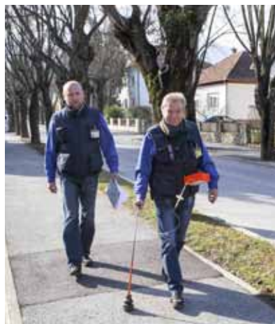
Ispitivanje uličnog plinovoda
